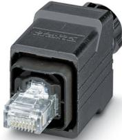
Connettore RJ45, grado di protezione: IP65/IP67, numero poli: 4, CAT5 (IEC 11801:2002), materiale: Plastica, tipo di connessione: Connessione rapida IDC, sezione di connessione: AWG 26- 22, uscita cavo: dritto, colore: nero
