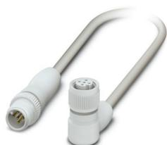
Cavo sensore/attuatore, 5-poli, PP-EPDM senza alogenati, grigio RAL 7035, Maschio diretto M12, codifica: A, con 3 LED, su Connettore femmina angolato M12, codifica: A, con 3 LED, lunghezza cavo: 1,5 m, Hygienic Design, con ghiera in plastica
