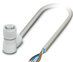
Cavo sensore/attuatore, 5-poli, PP-EPDM senza alogenati, grigio RAL 7035, estremità conduttore libera, su Connettore femmina angolato M12, codifica: A, con 3 LED, lunghezza cavo: 5 m, Hygienic Design, con ghiera in plastica
