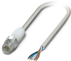
Cavo sensore/attuatore, 5-poli, PP-EPDM senza alogenati, grigio RAL 7035, Maschio diretto M12, codifica: A, su estremità conduttore libera, lunghezza cavo: 3 m, Hygienic Design, con zigrinatura in acciaio inox
