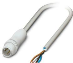
Cavo sensore/attuatore, 4-poli, PP-EPDM, grigio RAL 7035, Maschio diritto M12, codifica: A, su estremità conduttore libera, lunghezza cavo: 1,5 m, Hygienic Design, con ghiera in plastica
