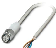
Cavo sensore/attuatore, 4-poli, PP-EPDM senza alogenati, grigio RAL 7035, schermata, estremità conduttore libera, su Connettore femmina diritto M12, codifica: A, lunghezza cavo: 10 m, Hygienic Design, con zigrinatura in acciaio inox
