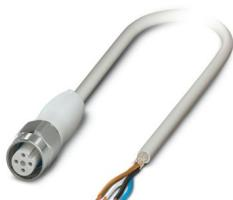
Cavo sensore/attuatore, 4-poli, PP-EPDM senza alogenati, grigio RAL 7035, schermata, estremità conduttore libera, su Connettore femmina diritto M12, codifica: A, lunghezza cavo: 3 m, Hygienic Design, con zigrinatura in acciaio inox
