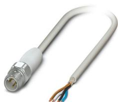
Cavo sensore/attuatore, 4-poli, PP-EPDM senza alogenati, grigio RAL 7035, schermata, Maschio diritto M12, codifica: A, su estremità conduttore libera, lunghezza cavo: 10 m, Hygienic Design, con zigrinatura in acciaio inox
