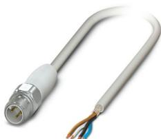
Cavo sensore/attuatore, 4-poli, PP-EPDM senza alogenati, grigio RAL 7035, schermata, Maschio diritto M12, codifica: A, su estremità conduttore libera, lunghezza cavo: 3 m, Hygienic Design, con zigrinatura in acciaio inox
