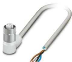
Cavo sensore/attuatore, 4-poli, PP-EPDM, grigio RAL 7035, estremità conduttore libera, su Connettore femmina angolato M12, codifica: A, con 3 LED, lunghezza cavo: 10 m, Hygienic Design, con zigrinatura in acciaio inox
