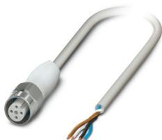
Cavo sensore/attuatore, 4-poli, PP-EPDM, grigio RAL 7035, estremità conduttore libera, su Connettore femmina diritto M12, codifica: A, lunghezza cavo: 10 m, Hygienic Design, con zigrinatura in acciaio inox
