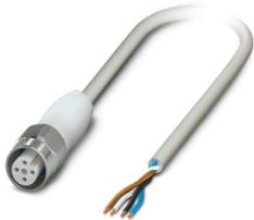
Cavo sensore/attuatore, 4-poli, PP-EPDM, grigio RAL 7035, estremità conduttore libera, su Connettore femmina diritto M12, codifica: A, lunghezza cavo: 1,5 m, Hygienic Design, con zigrinatura in acciaio inox
