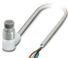
Cavo sensore/attuatore, 4-poli, PP-EPDM, grigio RAL 7035, Maschio angolato M12, codifica: A, su estremità conduttore libera, lunghezza cavo: 10 m, Hygienic Design, con zigrinatura in acciaio inox
