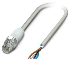
Cavo sensore/attuatore, 4-poli, PP-EPDM, grigio RAL 7035, Maschio diritto M12, codifica: A, su estremità conduttore libera, lunghezza cavo: 10 m, Hygienic Design, con zigrinatura in acciaio inox
