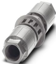
Connettore per linee QUICKON, grigio, 4+PE poli, 1,0 mm<sup>2</sup> ... 2,5 mm<sup>2</sup> / 690 V / 20 A, per diametro cavi 6 mm ... 11 mm.
