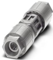
Connettore per linee QUICKON, grigio, 4+PE poli, 1,0 mm<sup>2</sup> ... 2,5 mm<sup>2</sup> / 690 V / 20 A, per diametro cavi 6 mm ... 11 mm.
