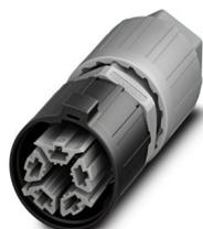
Connettore, product family: QPD, tipo di connessione: Connessione IDC, numero poli: 4+PE, 1 mm<sup>2</sup> ... 2,5 mm<sup>2</sup>, 690 V, 20 A, PA, grigio, diametro esterno conduttore: 9 mm ... 16 mm
