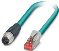
Cavo Ethernet confezionato, schermato, 4 coppie, AWG 26 flessibile (7 fili), RAL 5021 (azzurro mare), connettore M12 su connettore RJ45/IP20, Line, lunghezza 15 m
