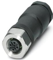
Connettore, 5-poli, Femmina diritto M12, codifica: A, Connessione a vite, materiale zigrinato: Acciaio legato 1.4404, connessione a vite per cavo Pg11-DUO, diametro esterno conduttore 2,1 mm ... 3 mm / 4 mm ... 5,2 mm
