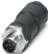
Connettore, 5-poli, Maschio diritto M12, codifica: A, Connessione a vite, materiale zigrinato: Acciaio legato 1.4404, connessione a vite per cavo Pg11-DUO, diametro esterno conduttore 2,1 mm ... 3 mm / 4 mm ... 5,2 mm
