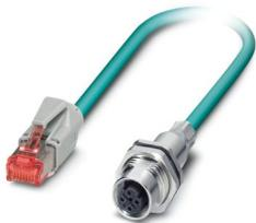
Cavo Ethernet confezionato, CAT5e, schermato, 2 coppie, AWG26 flessibile (7 fili), RAL 5021 (azzurro mare), connettore femmina da incasso M12, montaggio posteriore/a vite SPEEDCON su connettore maschio RJ45/IP20, Line, lunghezza 0,3 m
