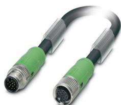
Cavo sensore/attuatore, 17 poli, PUR/PVC, nero RAL 9005, schermato, connettore maschio diritto M12 SPEEDCON, codifica A, su connettore femmina diritto, M12-SPEEDCON, lungh.: 20 m
