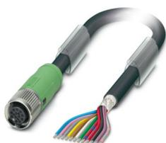
Cavo sensore/attuatore, 12-poli, PUR/PVC, nero RAL 9005, schermata, estremità conduttore libera, su Connettore femmina diritto M12 SPEEDCON, codifica: A, lunghezza cavo: 15 m
