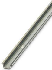
Guida di supporto, non perforata, Variante di imballaggio con 10 pezzi (20 m), a norma EN 60715, materiale: Acciaio, zincato, passivato a strato spesso, Profilo standard, colore: color argento
