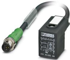
Cavo sensore/attuatore, 3-poli, PUR senza alogenati, grigio-nero RAL 7021, Maschio diritto M12 SPEEDCON, codifica: A, su Connettore per valvole BI (11 mm), con 1 LED , Circuito: Diodo Z, lunghezza cavo: 5 m
