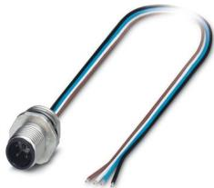
Connettore per apparecchi anteriore, Universale, 4-pol, Connnettore, diritto, M12, codifica: A, su estremità conduttore libera, Montaggio anteriore, Pg9, Fili singoli, lunghezza cavo: 0,5 m, 0,34 mm<sup>2</sup>, Filo in TPE, saldato
