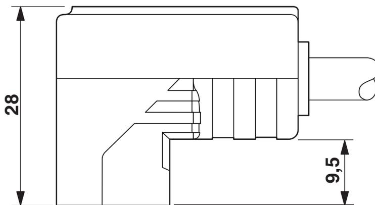
Connettore per valvole, formato C, vista laterale
