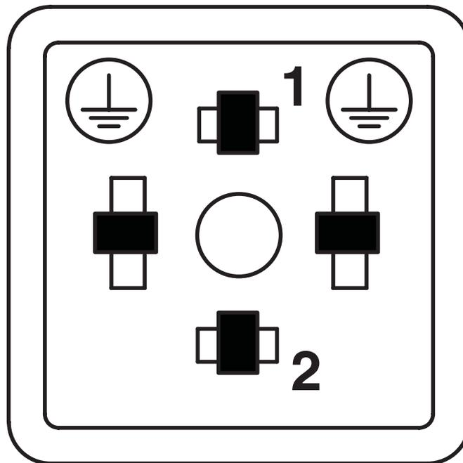
Pinning connettore per valvole, formato C
