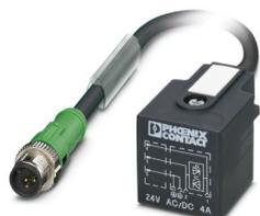
Cavo sensore/attuatore, 3-poli, PUR senza alogenati, grigio-nero RAL 7021, Maschio diritto M12, codifica: A, con 1 LED, su Connettore per valvole A, con 1 LED, Circuito: Diodo Z, lunghezza cavo: 1,5 m
