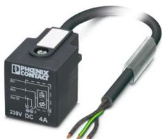
Cavo sensore/attuatore, 3-poli, PUR senza alogenati, grigio-nero RAL 7021, estremità conduttore libera, su Connettore per valvole A, con 1 LED , Circuito: Varistore 230 V, lunghezza cavo: 3 m
