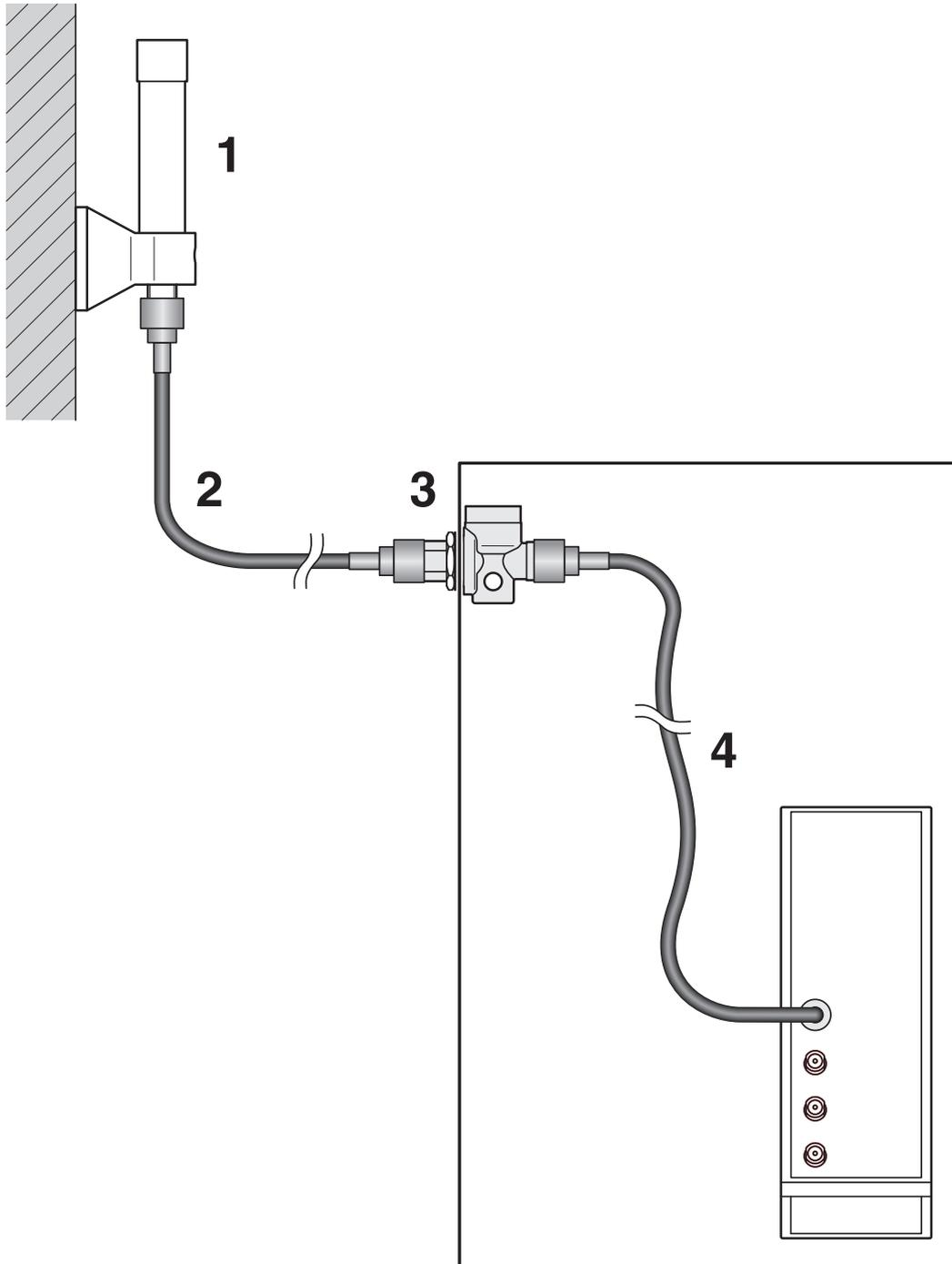
Esempio di montaggio (cavo antenna e protezione contro la sovratensione disponibili come accessori)
