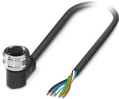
Cavo sensore/attuatore, 5-poli, PUR senza alogenati, grigio-nero RAL 7021, estremità conduttore libera, su Connettore femmina angolato M12 Push-Pull, codifica: A, lunghezza cavo: 1,5 m
