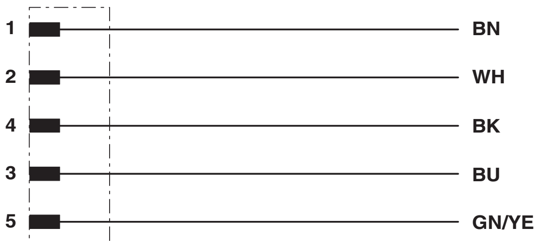
Equipaggiamento dei contatti del connettore M12
