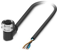
Cavo sensore/attuatore, 4-poli, PUR senza alogenati, grigio-nero RAL 7021, estremità conduttore libera, su Connettore femmina angolato M12 Push-Pull, codifica: A, lunghezza cavo: 5 m
