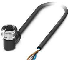
Cavo sensore/attuatore, 4-poli, PUR senza alogenati, grigio-nero RAL 7021, estremità conduttore libera, su Connettore femmina angolato M12 Push-Pull, codifica: A, lunghezza cavo: 1,5 m
