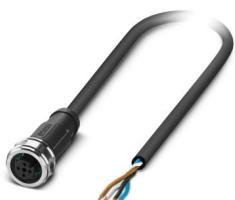
Cavo sensore/attuatore, 4-poli, PUR senza alogenati, grigio-nero RAL 7021, estremità conduttore libera, su Connettore femmina diritto M12 Push-Pull, codifica: A, lunghezza cavo: 1,5 m
