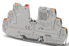
Interruttore di protezione elettronico a un canale per la protezione di utenze da 24 V DC in caso di sovraccarico e cortocircuito. Semplice ripartizione del potenziale con i componenti del sistema di morsetti componibili CLIPLINE complete. Con interblocco elettronico delle correnti nominali impostate. Il contatto di segnalazione si apre se il canale è stato disattivato da un errore o manualmente. Per l'installazione su guide DIN.
