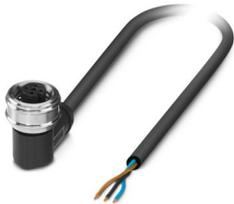
Cavo sensore/attuatore, 3-poli, PUR senza alogenati, grigio-nero RAL 7021, estremità conduttore libera, su Connettore femmina angolato M12 Push-Pull, codifica: A, lunghezza cavo: 10 m
