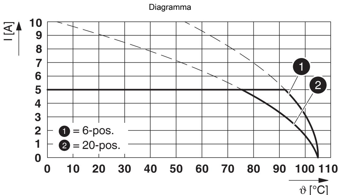
Tipo: DD21PC 0,85/...-2,5-X con DD21H 0,85/...-PT-2,5-X
