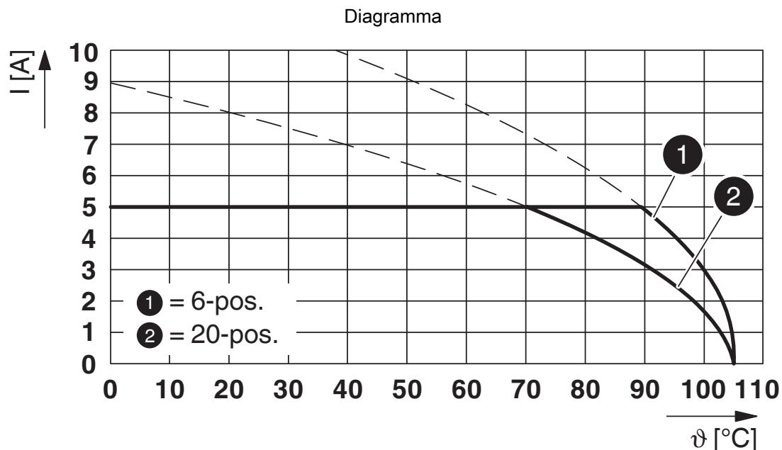
Tipo: DD21PC 0,85/...-2,5-Z con DD21H 0,85/...-V-2,5-Z
