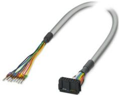
Cavo intestato; controllore: Axioline Realtime I/O; connessione 1: Fili singoli (8-poli) (I conduttori sono siglati e dotati di capocorda.); connessione 2: IDC/FLK conduttore femmina (1x 14-poli); lunghezza cavo: 1 m
