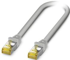
Cavo patch, grado di protezione: IP20, lunghezza cavo: 30 m, numero poli: 8, 10 Gbit/s, CAT6<sub>A</sub>, tipo di connessione: Connessione Pierce, sezione di connessione: AWG 26- 26, uscita cavo: dritto, Ethernet
