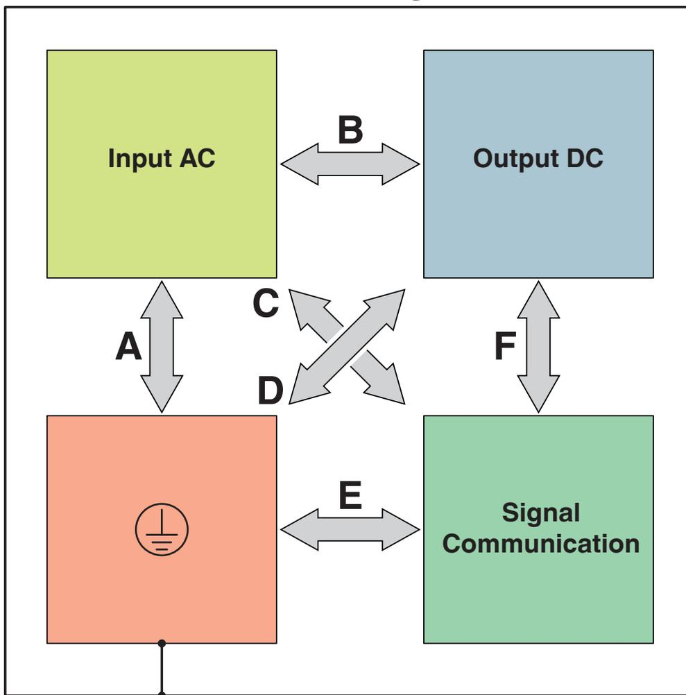
Percorsi di prova tensione di isolamento
