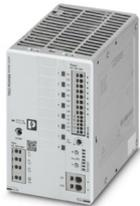
Alimentazione switching, TRIO POWER, Connessione Push-in, Interruttore di protezione elettronico a 8 canali, IO-Link, Montaggio su guida DIN, ingresso: 3 fase, uscita: 24 V DC / 20 A, regolabile da 24 V DC ... 28 V DC
