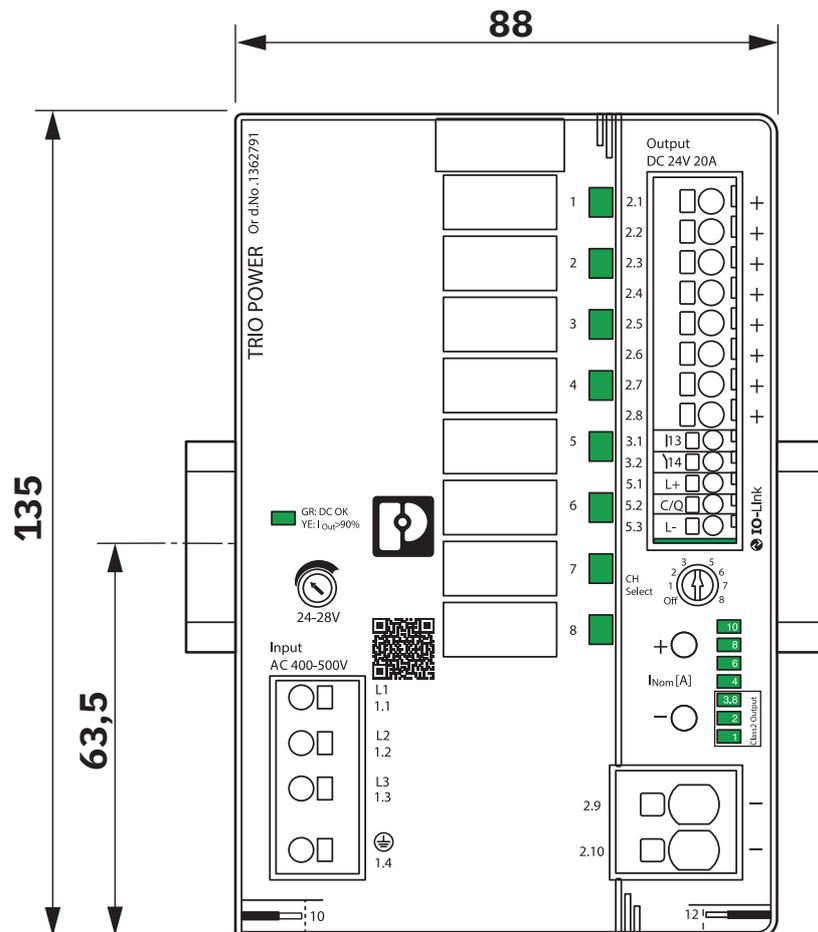
Dimensioni del dispositivo (misure in mm)
