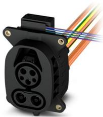
CHARX connect universal, DC CCS Typ 1, Presa di ricarica del veicolo, 200 A permanente, 1000 V DC, Fili singoli, lunghezza: 5 m, attuatore di bloccaggio: 12 V, 4 poli, Montaggio sulla parete anteriore e posteriore, M6, custodia: nero, per la ricarica con corrente continua (DC), IEC 62196-2, IEC 62196-3, La fornitura comprende un cappuccio di protezione per i contatti DC.
