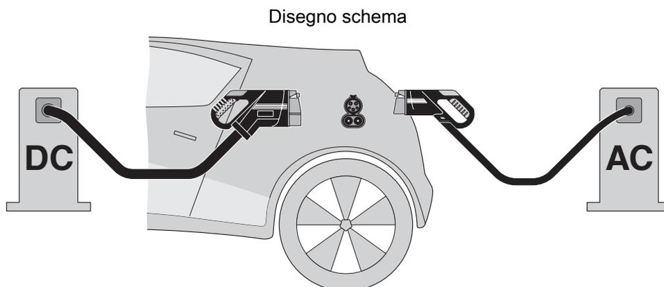
Principio del Combined Charging System (CCS) - sistema a inserzione a norma per ricarica per veicoli elettrici per la ricarica convenzionale con corrente alternata (AC) e la ricarica rapido con corrente continua (DC). Entrambe le spine di ricarica del veicolo sono adatte all'inlet veicolo CCS.
