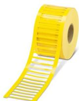
Targhetta per cavi, Rotolo, giallo, in bianco, siglabile con: THERMOMARK E.300 (D)/600 (D), THERMOMARK ROLL 2.0, THERMOMARK ROLL, THERMOMARK ROLL X1, THERMOMARK ROLLMASTER 300/600, diametro cavi: 0,6 ... 45 mm, tipo di montaggio: inserire, Numero dei cartellini singoli: 3000, altezza del campo di testo: 4 mm, larghezza del campo di testo: 23 mm
