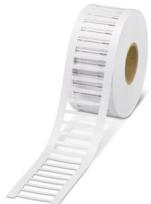
Targhetta per cavi, Rotolo, bianco, in bianco, siglabile con: THERMOMARK E.300 (D)/600 (D), THERMOMARK ROLL 2.0, THERMOMARK ROLL, THERMOMARK ROLL X1, THERMOMARK ROLLMMASTER 300/600, diametro cavi: 0,6 ... 45 mm, tipo di montaggio: inserire, Numero dei cartellini singoli: 3000, altezza del campo di testo: 4 mm, larghezza del campo di testo: 15 mm
