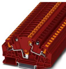
Morsetto sezionatore per conv. misura, tensione nominale: 1000 V, corrente nominale: 30 A, tipo di connessione: Connessione Push-in, Sezione di dimensionamento: 6 mm<sup>2</sup>, sezione: 0,5 mm<sup>2</sup> - 6 mm<sup>2</sup>, colore: rosso
