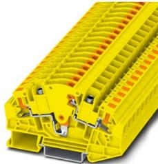
Morsetto sezionatore per conv. misura, tensione nominale: 1000 V, corrente nominale: 30 A, tipo di connessione: Connessione Push-in, Sezione di dimensionamento: 6 mm<sup>2</sup>, sezione: 0,5 mm<sup>2</sup> - 6 mm<sup>2</sup>, colore: giallo
