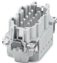
Inserto contatti, numero poli: 10+2 PE, dimensioni: B10, numero di connessioni per polo: 1, Spina, Connessione Push-in, 500 V, 16 A, 0,14 mm<sup>2</sup> ... 2,5 mm<sup>2</sup>, applicazione: Potenza, montaggio Click-in senza utensili
