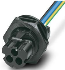
Connettore per apparecchi posteriore, Serie di prodotti: PRC 35, colore: nero, numero poli: 3, sezione del conduttore max.: 4 mm<sup>2</sup>, tensione di dimensionamento: 690 V AC, corrente nominale: 32 A, Tipo di connessione: Connessione a crimpare, Tipo di connessione del contatto: Spina, Questo articolo è disponibile anche con altre lunghezze di cavo. Per esigenze particolari contattare la filiale PHOENIX CONTACT locale.
