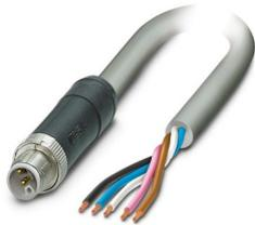
Cavo di alimentazione, 5-poli, PUR senza alogenati, grigio RAL 7001, Maschio diritto M12, codifica: L, su estremità conduttore libera, lunghezza cavo: 0,5 m, per corrente continua fino a 12 A / 63 V
